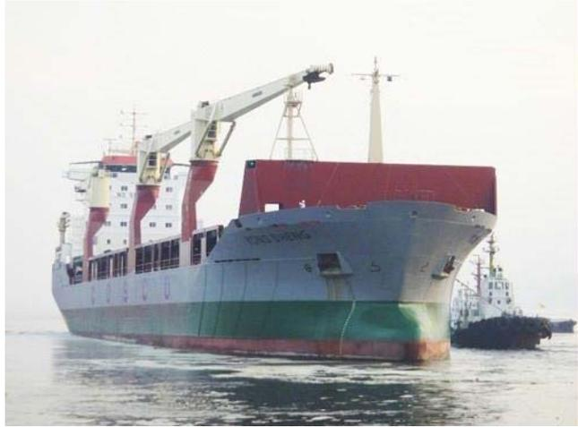
此次永盛轮从太仓出发通过北极东北航道到达鹿特丹航程为 7931 海里，航行 27 天，比传统的经马六甲海峡、苏伊士运河的航线缩短航程 2800 多海里，航行时间减少 9 天。“永盛”轮总载重量 19461 吨，船长 155.95 米，船宽 23.70 米，设计船速 14 节，为一艘多用途船。交通运输部安全总监、中国潜水打捞行业协会理事长宋家慧参加此次首航，这是中国商船首次尝试经由北极东北航道到达欧洲。
