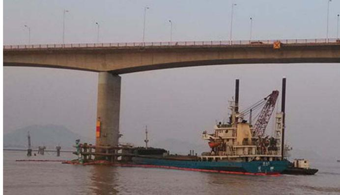
赴现场对难船进行施救。满洋公司采用 18 立方米抓斗船“满洋浚 1”对船上的砂子进行清理，然后用三条拖轮进行拖拽，终于在 8 月 9 日成功将难船拖离主航道至安全地带。
