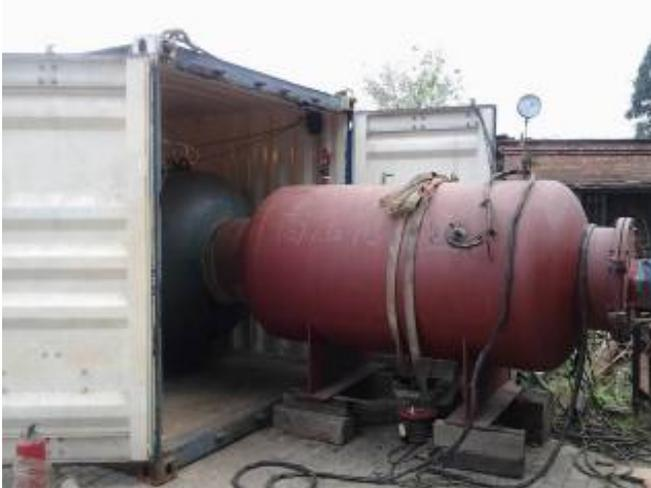
技术人员首先在制作的高压舱内 0.7Mp 压力下，由自动焊机进行焊接，根据预先制定的技术方案由多台焊机匹配十几种型号焊条进行了上百次焊接试验，确定了
